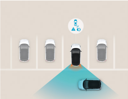
מערכת למניעת פגיעה ברכב חוצה בעת נסיעה לאחור (RCTA) מערכת המתריעה מפני רכב החוצה את מסלול הנסיעה לאחור.
